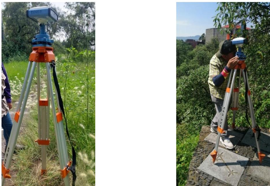
Figura 1. Obtención de puntos GPS de alta precisión para verificación de límites. Agosto-septiembre, 2023.
