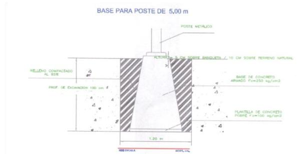
Figura 44Detalle constructivo (corte esquemático) de la construcción de la base para la colocación del poste para la cámara de vigilancia.
