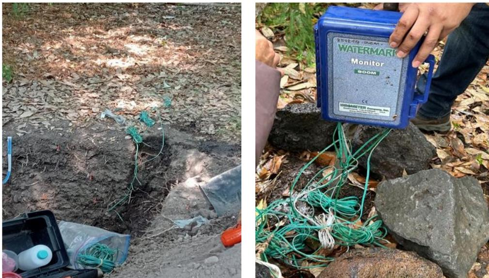
Fig. 15. Instrumentación de los perfiles de suelo con los bloques de yeso para el monitoreo de humedad.
